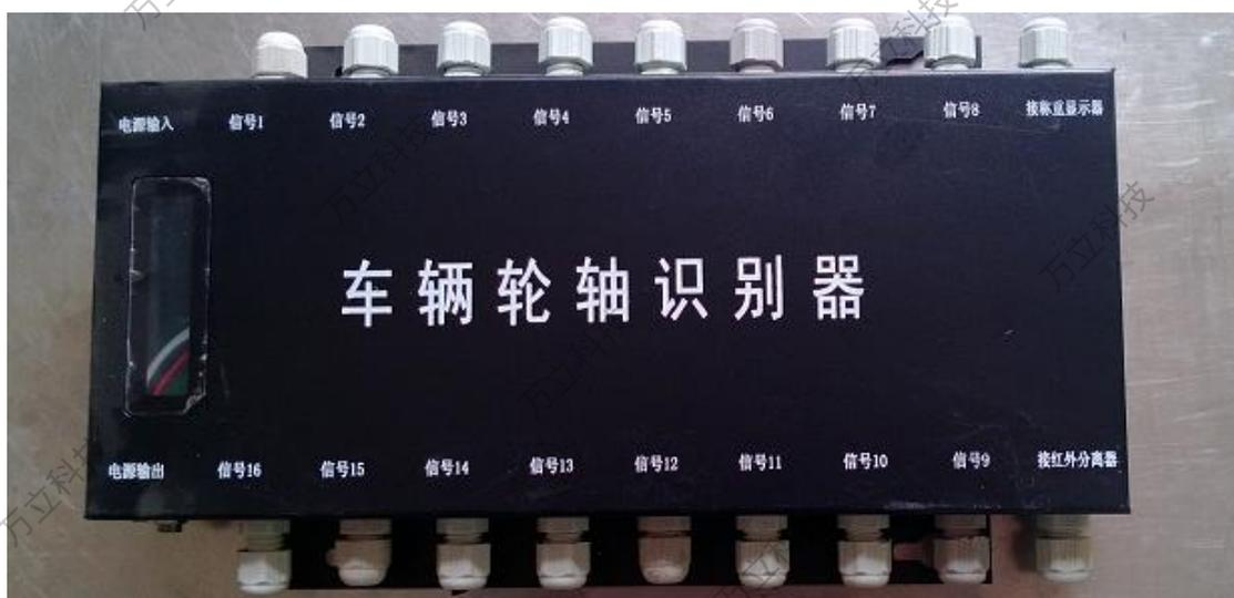
图 3-6.2 机械式车辆轮轴识别器接线盒
