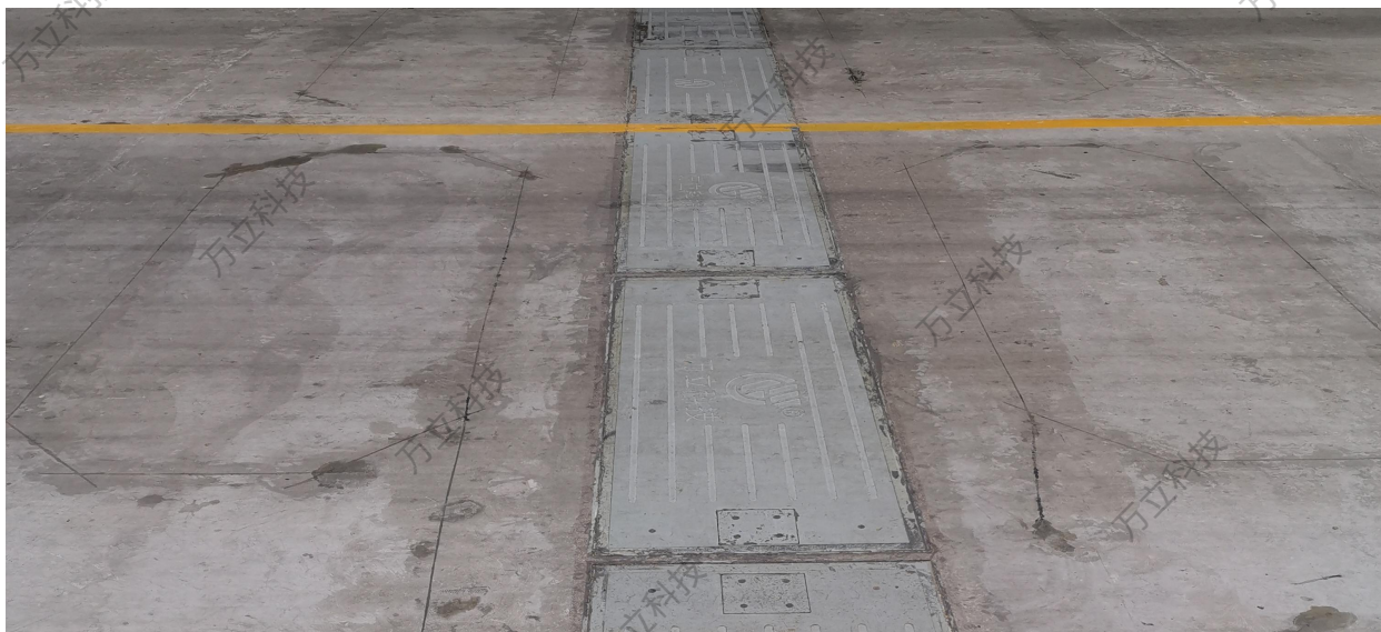
图 3-5 板模块式动态汽车衡与车辆分离器（地感）
