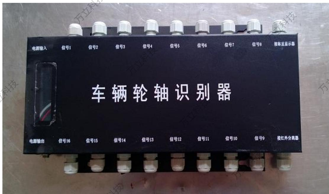
图 4-3 轮轴检测单元车辆轮轴识别器
