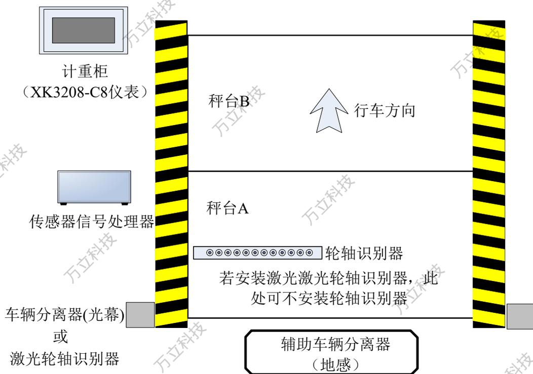
图 3-2 仪表配套产品结构图
