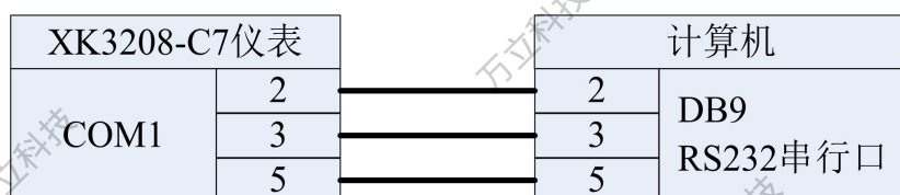
图 4-5 仪表与计算机接线图
