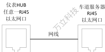
图 4-7 仪表与车道服务器接线图
