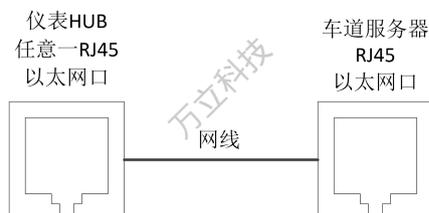
图 4-7 仪表与车道服务器接线图
