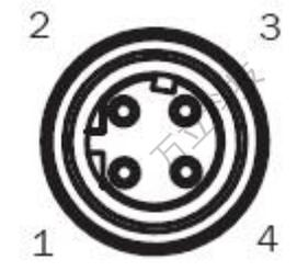
本系统激光传感器只使用“电源”插座和“以太网”插座，如果传感器自带的网线和电源线长度不够，可自行接上相应长度的网线和电源线，**延长所用电源线的截面积至少是 1mm<sup>2</sup>**，延长网线时，保留传感器自带网线的 RJ45 插头一端，在自带网线的中间截断，接入延长线。网线和电源线的连接处应用焊锡焊住，并且用防水胶带包裹住。
