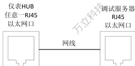
图 4-8 仪表与调试服务器接线图
